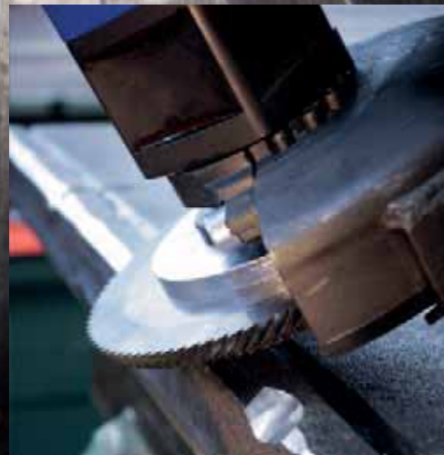
Fräsring beim Fräsen einer Phase
